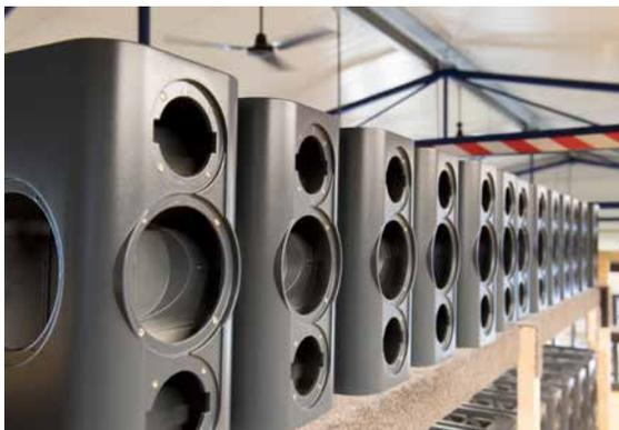
Reinraumatmosphäre: Schrittweise werden die massiven Rohgehäuse mit Elektronik und Chassis gefüllt und abschließend die markanten Aluminium-Intarsien angebracht. Auch die Montage der Control-Fernbedienungen erfolgt direkt bei Kii Audio.
