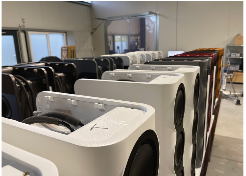
Blick in die Kii-Audio-Fertigung mit vormontierten BXT-Modulen
