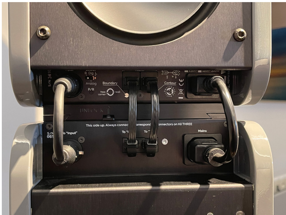
Auch die Stromversorgung wird von der Kii Three zur BXT durchgereicht
